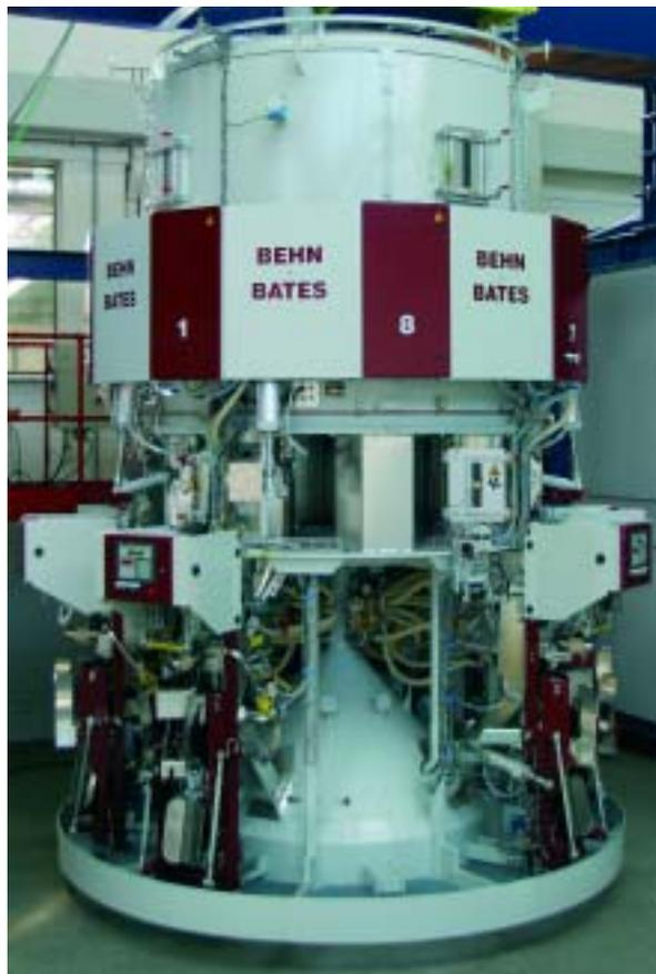
Rotoseal con sistema de llenado por aire – se puede extender de 6 a 8 bocas
