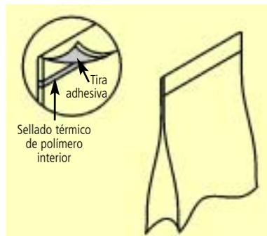
Esquema del sellado superior tipo pinch top
