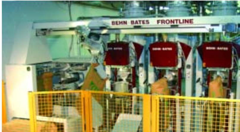
Aplicador automático de sacos FRONTLINE para su utilización con 3 ensacadoras neumáticas
