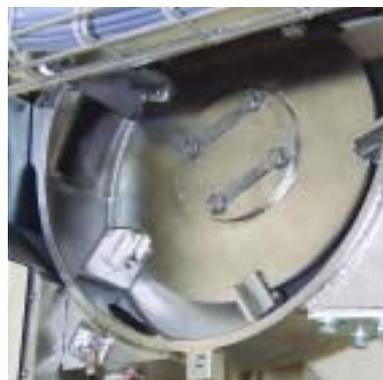
Turbina de llenado vertical abierta para mantenimiento
